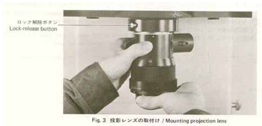
図 投影レンズの取付け方法
