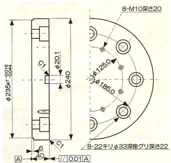
図5 ステージ側フランジ(着脱可)
