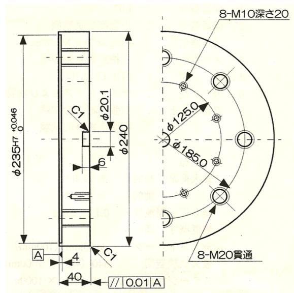
図4 ロードセル側フランジ(着脱可)
