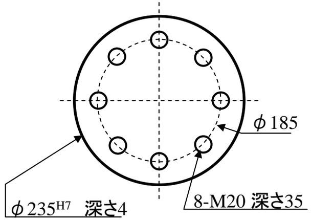
図3 ステージ中心にあるジグ取り付け部寸法
