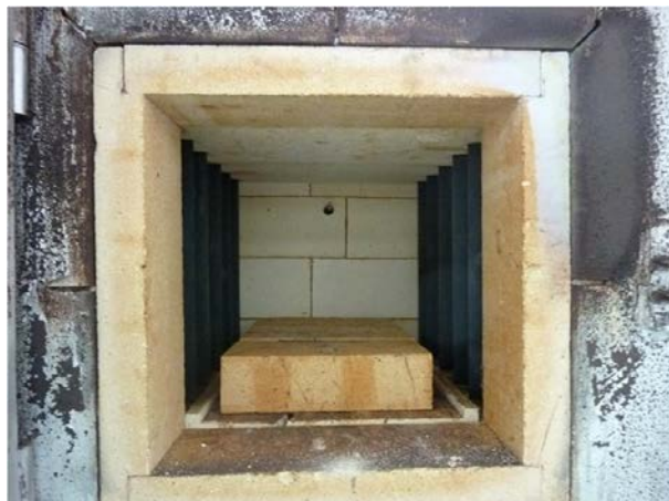
電気炉の炉内
