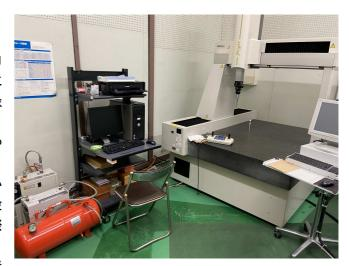
プローブ先端の球は、赤いルビー球を使用している。測定対象がアルミニウム系の場合は凝着してしまうため、チタンプローブに変更する必要がある。
