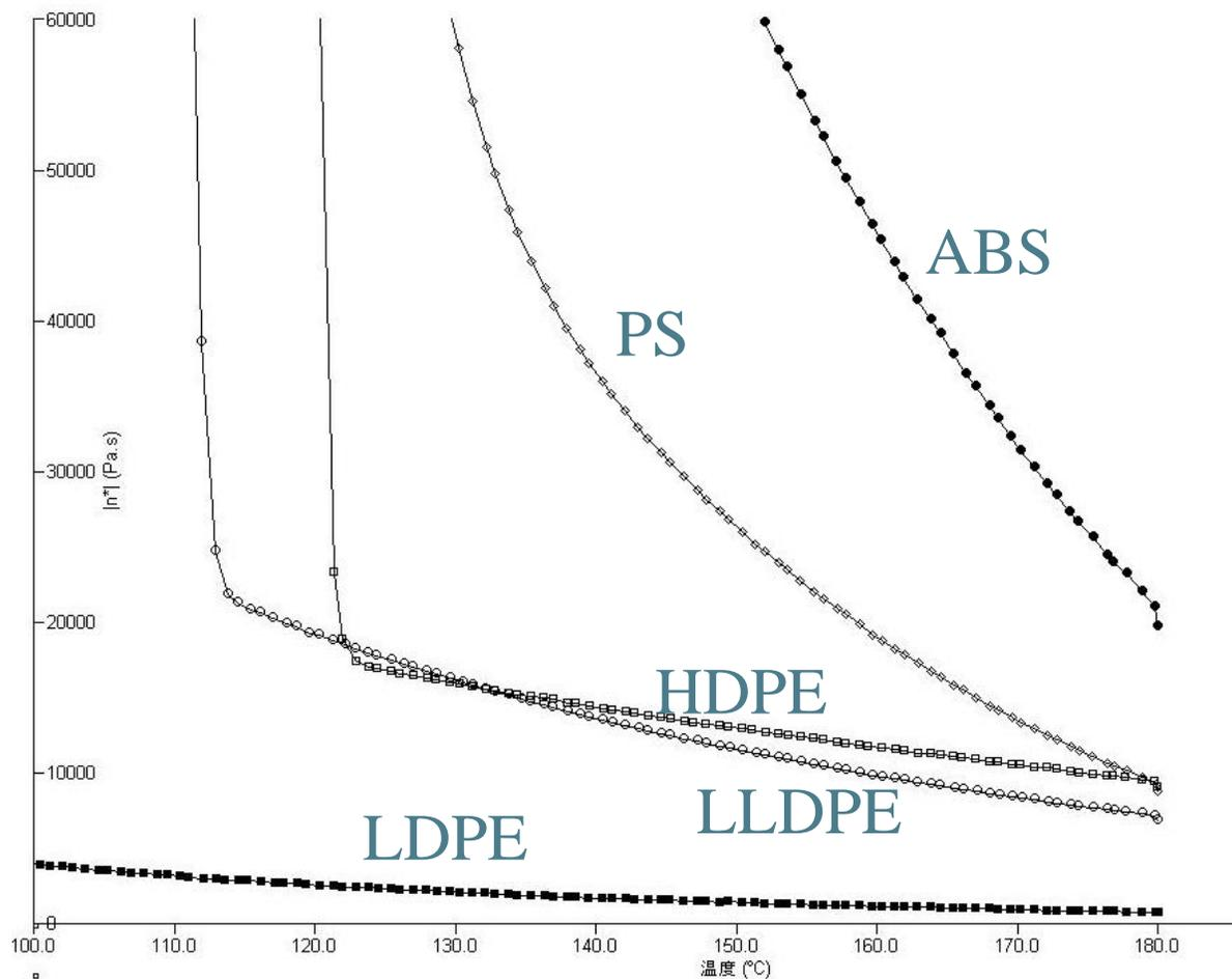
振動モードで温度を変化させながら測定した複素粘度  $\eta^*$
