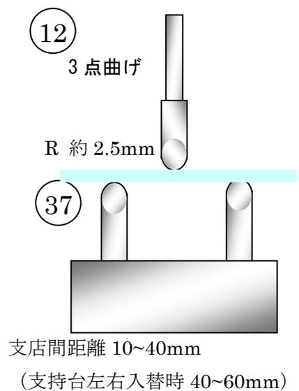
自作の場合 ロードセルへの取り付けは、M6 (長さ 9mm 程度) のネジ
