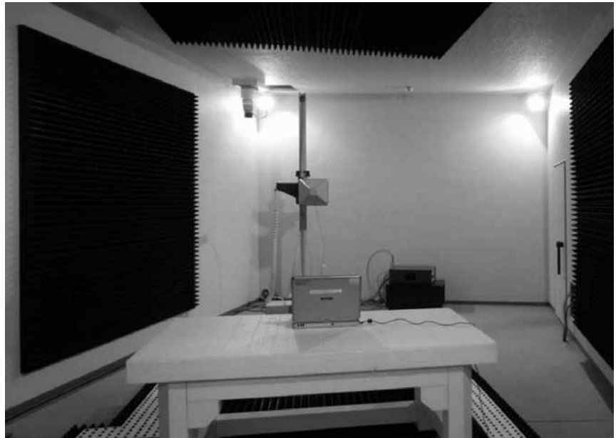
電磁耐性評価室における測定風景
