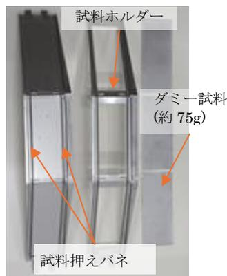
※試料ホルダーを利用しない場合 (枠に直接吊るす等) も、照度を考慮しながら、ホルダー用枠に直接固定出来る範囲で設置可能。ただし、送風や温度変化、重量の偏りなどに注意が必要
