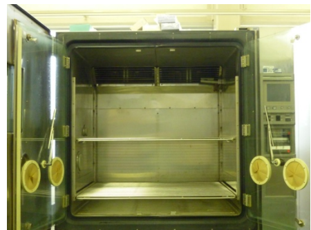
恒温恒湿槽の槽内
