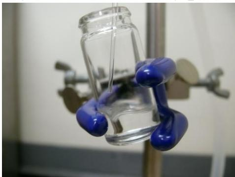
加熱で容器が冷却され、水滴が付着する。冷えてくると揮発が緩やかになるので、必要に応じてドライヤーで加熱する。
